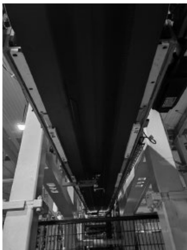
图3 现场改造后，加有尼龙压条的传送带
