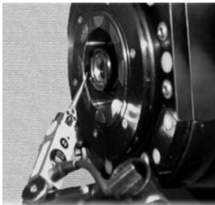
图 3 主轴径跳的检测
