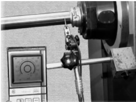
图 15 在近主轴端检测径跳
