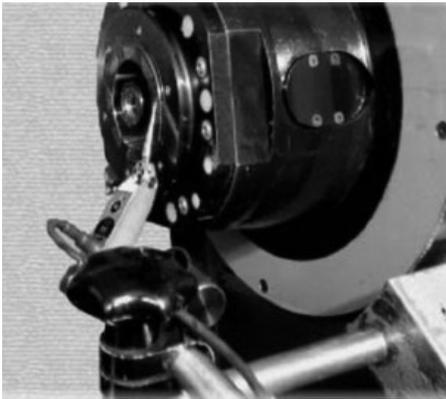
图 2 主轴端跳的检测
