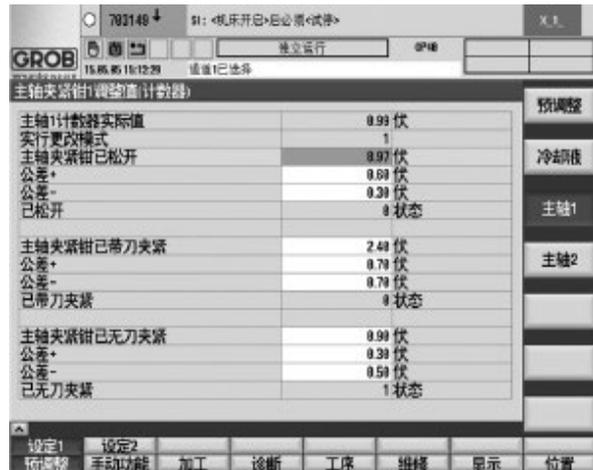
图 20 主轴夹钳调整值界面
