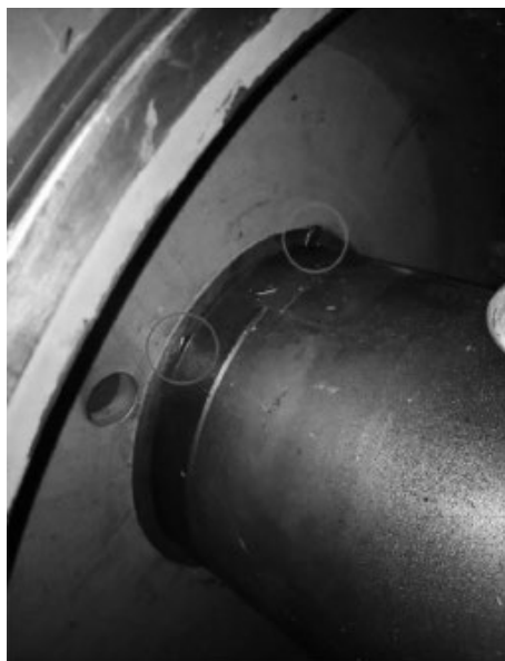
图 15 轮辋装配垫片安放示意图
