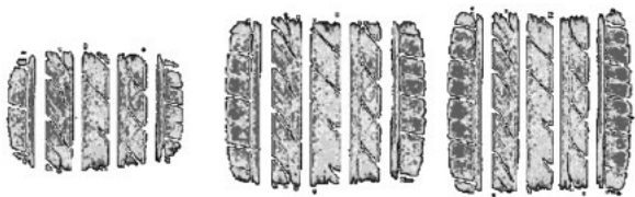
图 11 钢质轮辋印痕图
